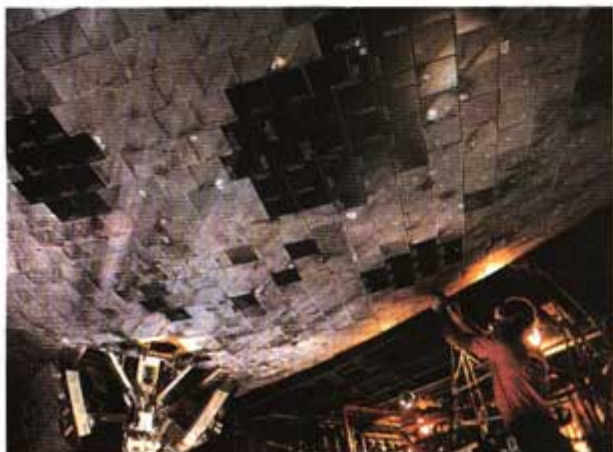
图 3-34 在哥伦比亚号航天飞机再次发射以前，上一次发射时受损的陶瓷防护片必须更换。如果许多防护片脱落，那将会发生什么情况
