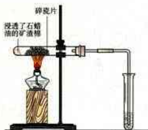
图 3-6 石蜡油分解实验
