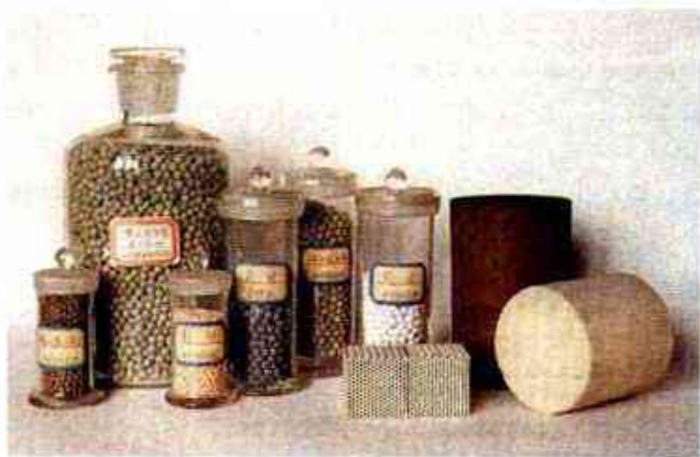
图 2-18 净化汽车尾气的 催化剂及其载体
