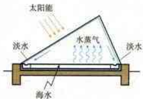
图 4-4 太阳能蒸发原理示意图
