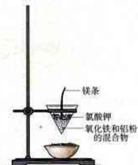
图 4-1 铝热反应的实验装置
