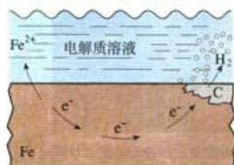
图 3-15 钢铁的电化学腐蚀示意图
