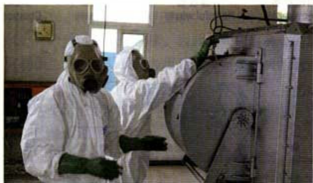
图 4-38 抗击非典期间，北京市处理医疗垃圾采用的焚烧炉内温度高达 800~1 100 ℃，能将病毒全部杀死，而且二噁英等有害物质的排放量达到国家标准
