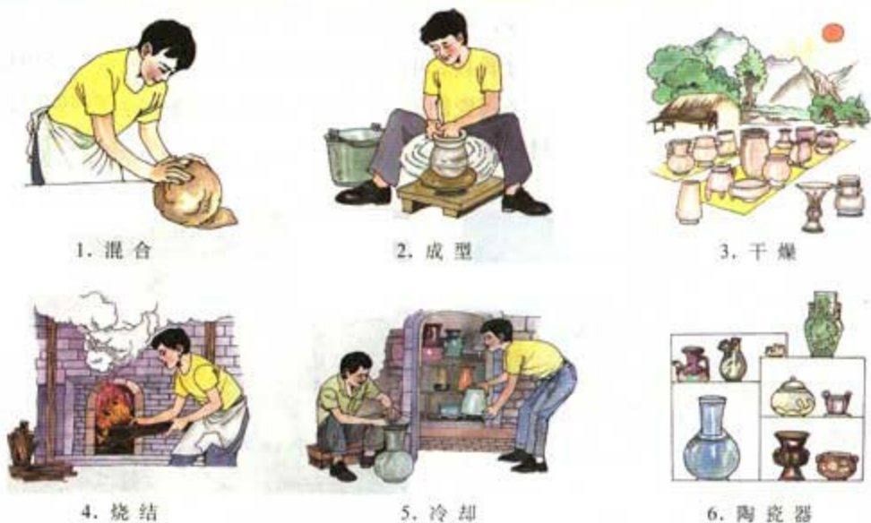
图 3-27 陶瓷器制造过程示意图
