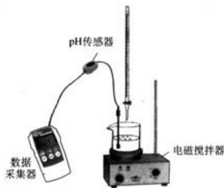
图 3-17 应用 pH 传感器的酸碱滴定装置
