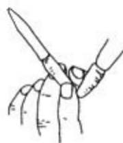
图 3-11 除去碱式滴定管胶管中气泡的方法
