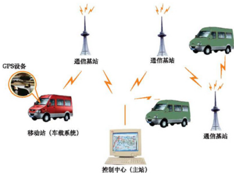
图 6.6 运钞车实时监控系统结构
