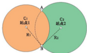
图 4.5 二维定位原理
