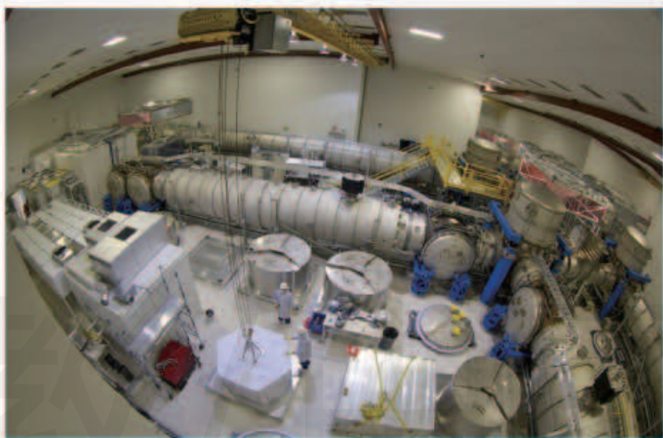
图 1.3.3 探测引力波实验装置
