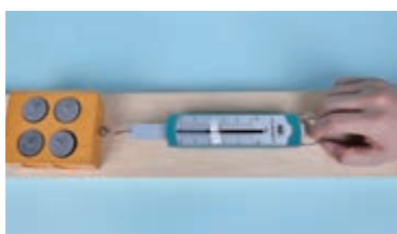
图 3.2-4 测量静摩擦力的实验装置
