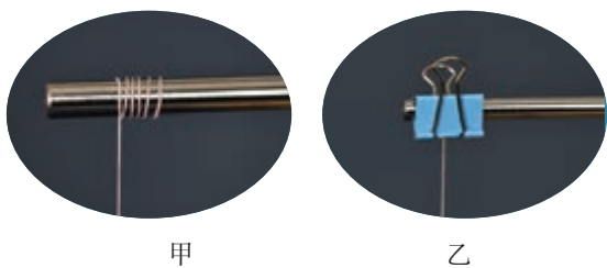
图 2.5-2 细线上端的两种悬挂方式
