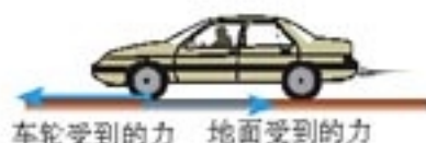
图 4.5-8 汽车的驱动轮向后推动地面，它们获得的反作用力推动汽车前进。为了清晰，画图时两个力的作用点分开了一些。
