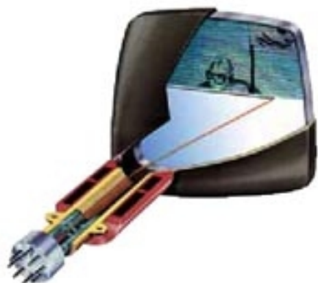
图 0-2 电视机显像管的剖面图
