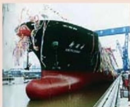
图 3.3-9 轮船的水下部分呈流线型
