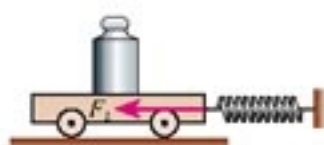
乙 被压缩的弹簧使小车向左运动
