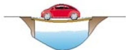
图课-3 简单的梁式桥易弯曲
