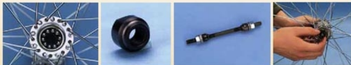
图3.3-7 安装自行车的滚动轴承
