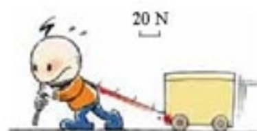
图3.1-2 力的图示表示作用在小车上的力为80 N，箭头的方向表示小车受力的方向。
