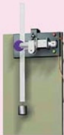
图2.5-1 用打点计时器研究自由落体运动
