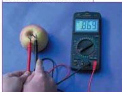
图 1.2-3 测量水果电池的电动势
