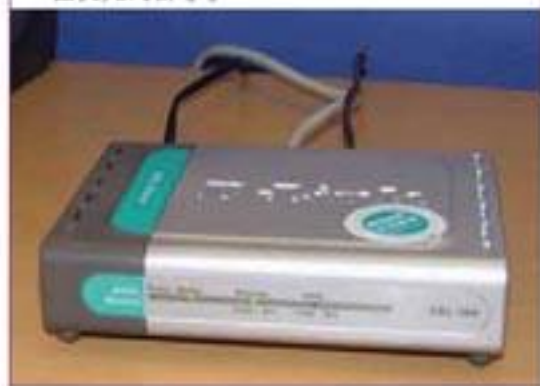
图 5.2-10 调制解调器。现在生产的计算机大多已把调制解调器作为标准配置安装在机壳内部了。
