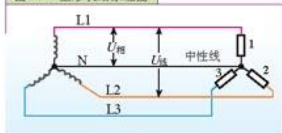
图 4.3-4 星形联结原理图
