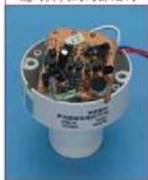
图 1.5-6 声控—光控自动延时开关的内部结构
