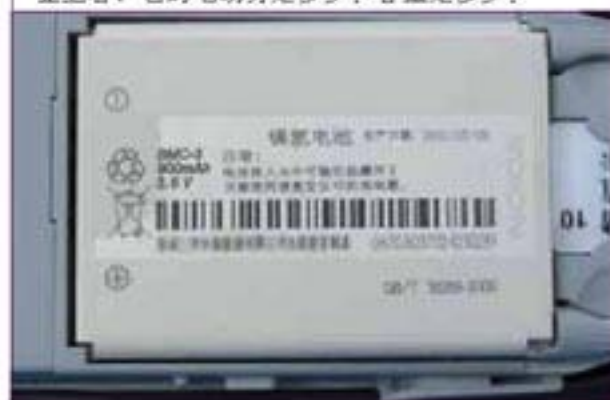
图 1.2-4 这是移动电话中使用的一种电池。从标签上看，它的电动势是多少？容量是多少？
