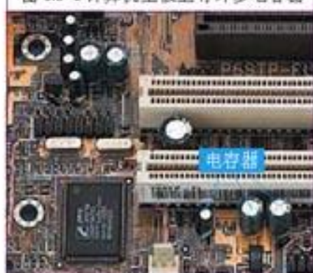
图 1.5-1 计算机主板上有许多电容器
