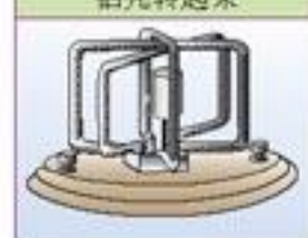
图 4.3-9 旋转磁场能使铝壳转起来
