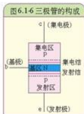
图 6.1-7 三极管的结构和符号
