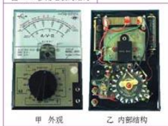
图 1.3-1 多用电表的结构
