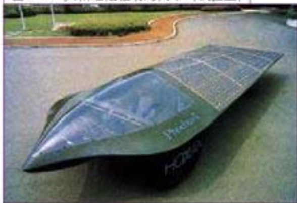
图 1.2-12 太阳电池驱动的汽车（试验型）
