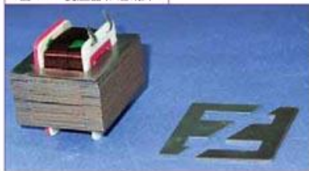
图 4.2-2 变压器和硅钢片
