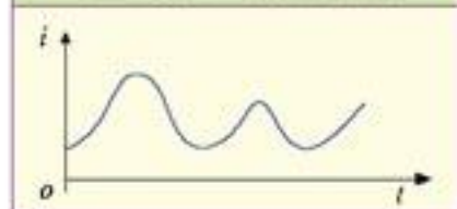
图 5.2-8 音频电流的大小模拟声压的变化，是模拟信号。
