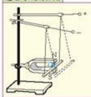
图 2.1-5 磁场对通电导线的作用
