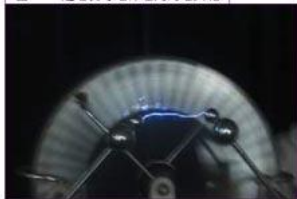
图 1.1-9 起电机导电杆之间的电火花
