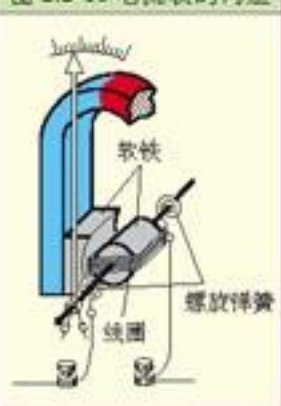
图 2.2-10 电流表的构造
