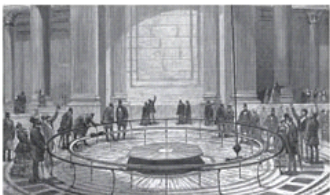
傅科摆。1851 年, 傅科 (J. Foucault) 在巴黎万神殿用长 67 m 的单摆演示了地球自转的效应。摆的周期超过 16 s。
