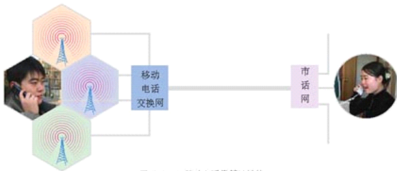
图 14.4-7 移动电话靠基站转换
