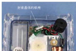
图14.2-4 石英电子钟的振荡器里用的晶体
