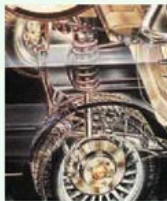
图 11.5-6 汽车的减振系统
