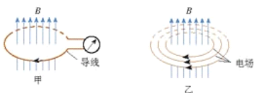
图 14.1-1 变化的磁场产生电场
