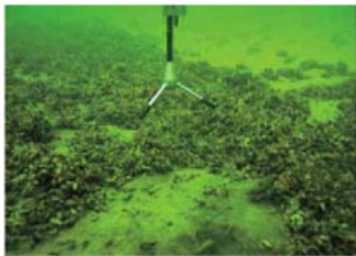
多普勒测速仪测量水在河底的流速，为养殖场寻找适合鲜蚕生长的场所。
