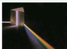
图 13.4-9 光在折射时发生色散的示意图
