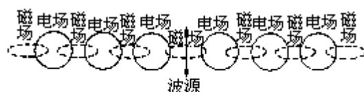
电磁场振荡的传播机制示意图
