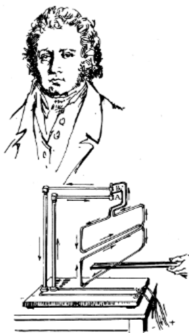
安培及安培研究“电流对电流的相互作用”的实验装置
