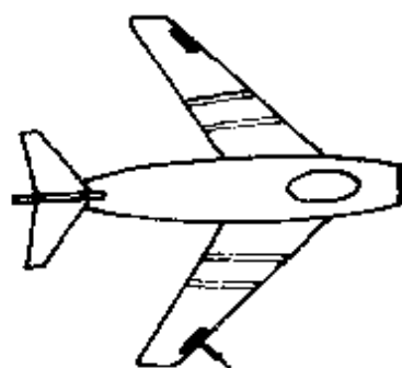
图 103 带抗颤振加厚区的飞机
