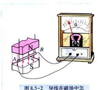
图 8.5-2 导线在磁场中怎样运动才能产生感应电流？
