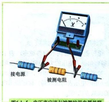
图 6.1-5 电压表应该与被测的用电器并联
