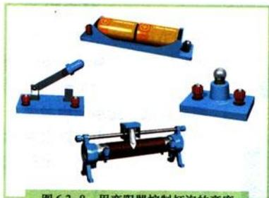
图 6.3-8 用变阻器控制灯泡的亮度
