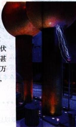
图 6.1-1 起电机的高压放电
