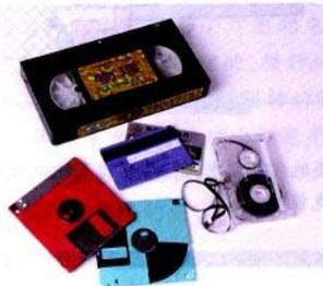
图 8.5-8 利用磁性材料记录信息的产品
