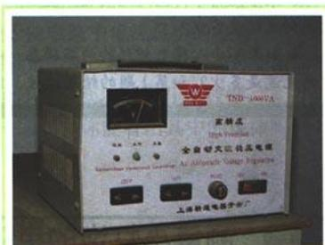
图 6.4-3 有些地区电压不稳：在用电高峰时只能达到 150 V 左右，深夜时会升到 230 V 以上。为了保护电冰箱等用电器，有的家庭使用“稳压器”。把稳压器的输入端接在电源上，再把电冰箱等用电器插在稳压器的输出端，用电器就能得到比较稳定的电压。
