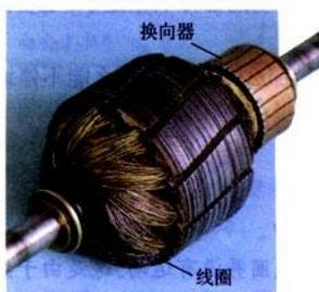
图8.4-7 实际的直流电动机的转子
