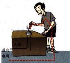
图6.4-1 试电笔内有一个阻值很大的电阻, 使得通过人体的电流很小。
