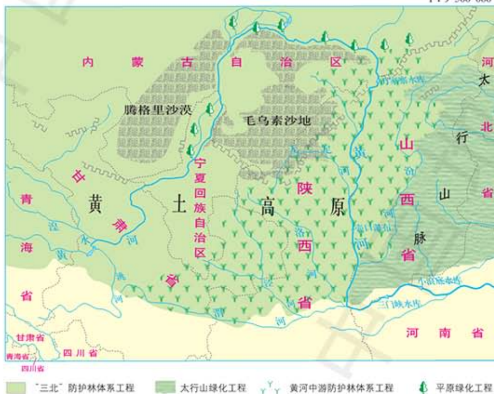
治理水土流失的生物措施 生物措施主要是植树种草，增加地表植被的覆盖率，减轻雨水对地面的冲刷，减缓水的流速，从而减少水土流失。
