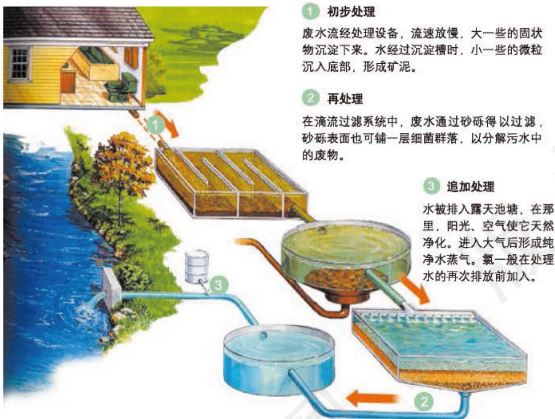
图2-3-6 污水处理流程图
