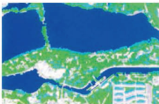
图2-3-9 第二级分类后的影像 在已有工作的基础上，计算机进行第二级分类，将陆地进一步细分为植被、非植被和阴影。
