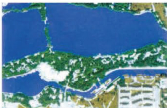
图2-3-10 第三级分类后的影像 计算机进行的第三级分类是在区分草地和树木的基础上，将阴影进行分类。由于阴影落在不同的地物中，例如房屋的阴影落在草地和水泥地上，湖边树及湖岸的阴影落在水体中，其他一些树的阴影落在树丛上等，因此需要对阴影进行正确归属，才能得到最后的分类结果——水体、植被、非植被。
