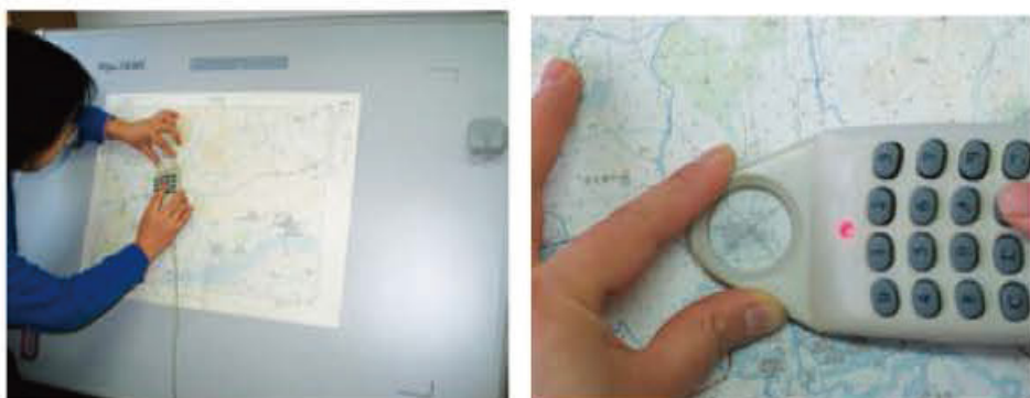
图4-2-1 使用数字化仪手扶跟踪数字化 左为数字化仪图板,右为对地图进行手扶跟踪数字化作业。
