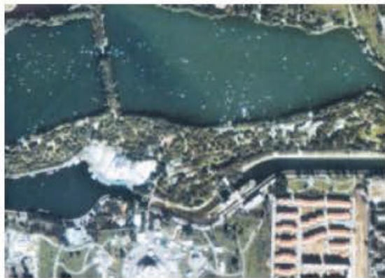
图2-3-7 2002年10月5日获取的IKONOS真彩色影像。影像空间分辨率为1米。成像区域土地利用类型主要为水体、植被、非植被（包括建筑物、道路和工地裸露地面等）。
