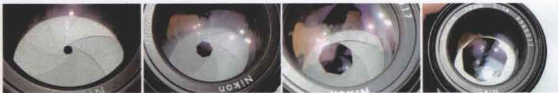
▲ 透过镜头表面看到的光圈（分别是调节至22、8、4、2时光孔的大小）
