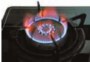
图7-31 燃气燃烧出现黄色火焰
