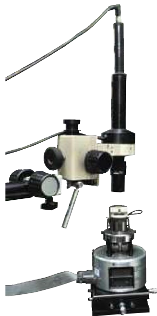
图6 扫描隧道显微镜 用于观察原子在固体表面的排列情况等
