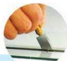
玻璃刀头上镶的金刚石 可用来裁玻璃
