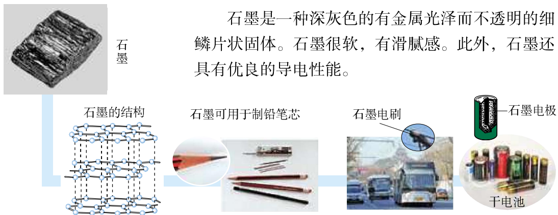
图6-2 石墨的结构及用途
