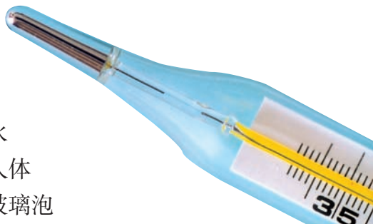
图3.1-4 体温计 （细管处水银柱断开）
