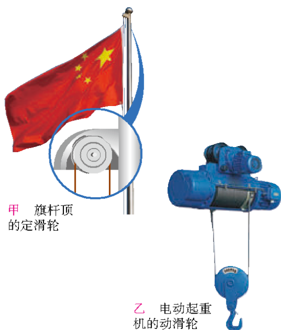
图12.2-2 定滑轮和动滑轮的应用
