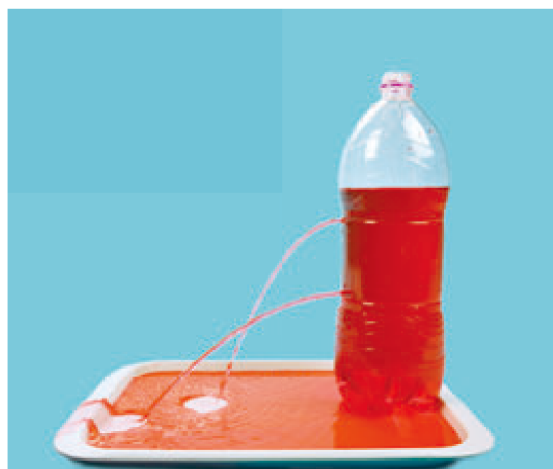
图9.2-1 液体从容器侧壁的孔中喷出
