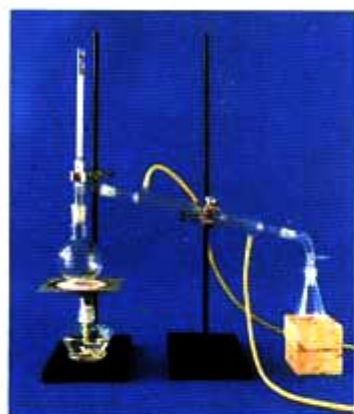
图 1-4 实验室制取蒸馏水的装置
