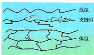
图 3-34 高分子链结构示意图
