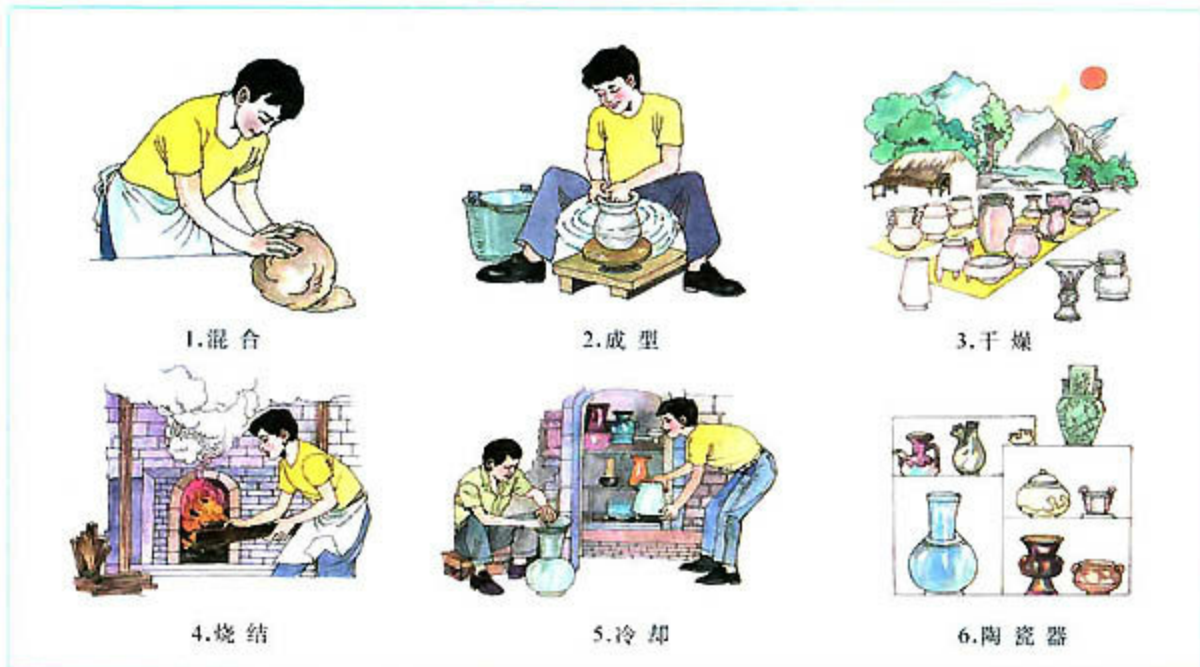
图 3-3 陶瓷器制造过程示意图
