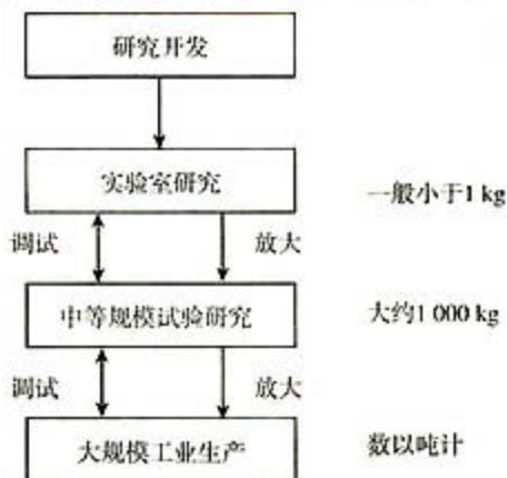
图 1-14 实验研究与实际生产的关系示意图
