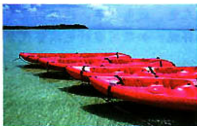
图 3-37 玻璃钢制成的船体
