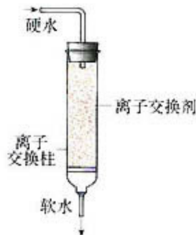
图 2-1 离子交换法软化水示意图
