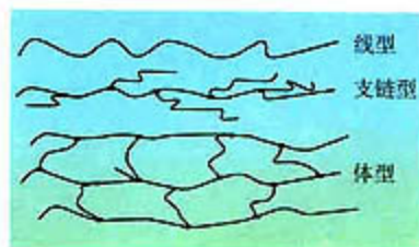
图 3-34 高分子链结构示意图
