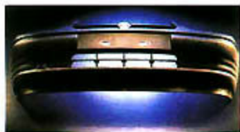
图 3-32 聚丙烯用于制造汽车保险杠
