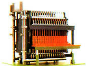
图 2-10 离子交换膜电解槽
