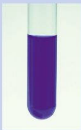
图 3-9 苯酚与 \text{FeCl}_3 的反应
