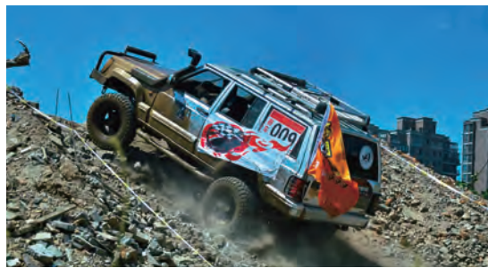
图 8.1-4 汽车上坡时必须使用低速档
