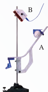
图 5.3-5 用传感器研究平抛运动的装置
