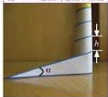
图 1.1-10 螺丝的螺距示意图
