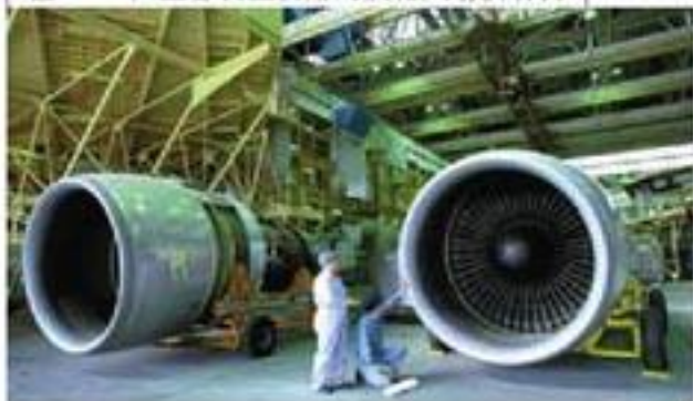
图 4.4-3 大型客机上使用的涡轮风扇发动机
