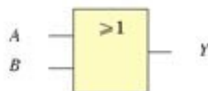
图2.10-7 “或”门的符号。矩形中的“>1”象征者：当1个或多个输入端为1时，输出端就是1。
