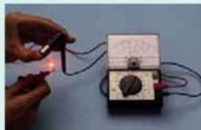
图 6.5-3 用欧姆表检测发光二极管
