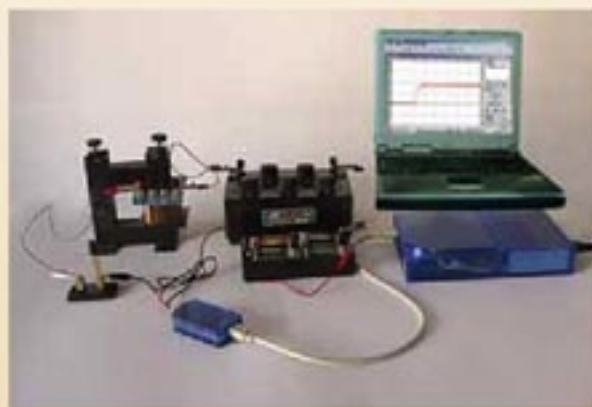
图 4.6-5 显示通电时线圈对电流影响的实验
