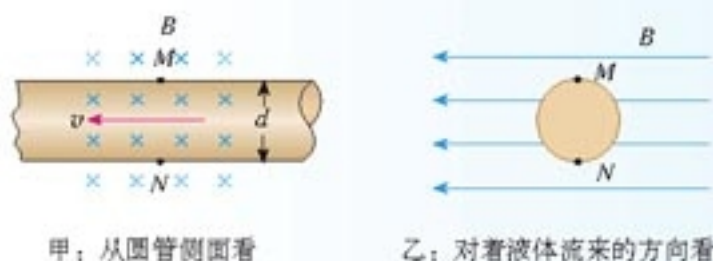
图 4.4-8 电磁流量计的示意图
