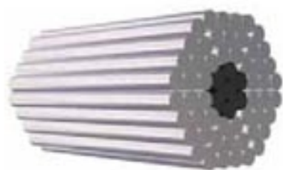
图5.5-1 远距离的输电线大多是多股导线绞合而成的。有一种绞合线，中心是钢线，它的机械强度大；周围是铝线，它的电阻小、重量轻。
