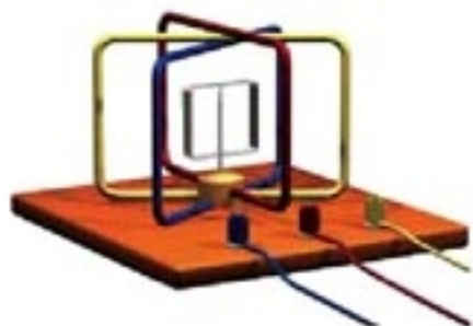
图 4.7-9 这样配置的线圈，连接到三相电源时能产生旋转的磁场。
