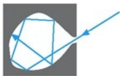
图 17.1-1 如果在一个空腔壁上开一个很小的孔，那么射入小孔的电磁波在空腔内表面会发生多次反射和吸收，最终不能从空腔射出。这个小孔就成了一个绝对黑体。
