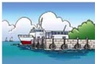
图 16.6-2 船与码头相碰时，旧轮胎能延长船与码头的作用时间，减小作用力。
