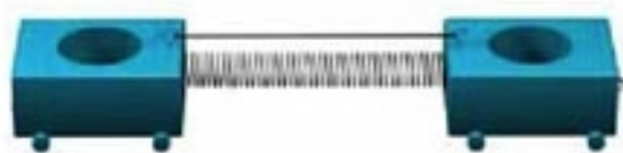
图 16.2-4 烧断细线后，尽管两辆小车都将获得动量，但它们动量的矢量和仍然为零。
