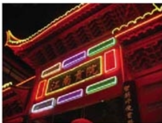
图 18.4-3 各种气体原子的能级不同，跃迁时发射光子的能量各异，因此利用不同气体可以制成五颜六色的霓虹灯。
