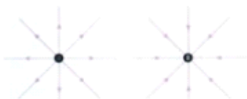
图 1.3-6 点电荷的电场线呈辐射状, 正电荷的电场线向外至无限远, 负电荷则相反。
