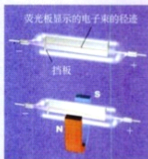
图3.5-1 用阴极射线管研究磁场对运动电荷的作用
