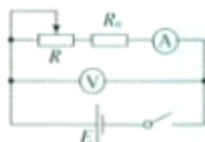
图2.10-6 测量蓄电池的电动势和内阻
