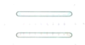
图1.3-10 相距很近的一对带等量异号电荷的平行金属板，它们之间的电场除边缘外，可看做匀强电场。
