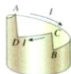
图 2.7-2 闭合电路的电势。A、B 两个位置与上图中的 A、B 相对应, D、C 则分别代表电池的溶液中与 A、B 两电极靠近的位置。
