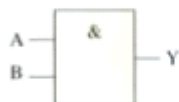
图 2.11-4 “与”门的符号。矩形中的“&”在英语中代表“and”,具有“与”的意思。它象征着:只有 A 与 B 两个输入端都是 1 时,输出端才是 1。
