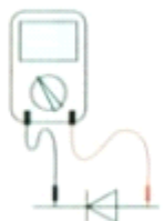
图2.9-5 测二极管反向电阻
