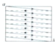
图3.5-5 电子束在荧光屏上扫描一行之后,迅速返回(虚线),再做下一行扫描,直到荧光屏的下端。
