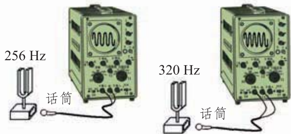
图 1-25 用示波器显示声音的频率
