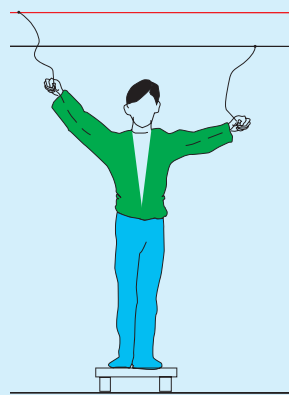
在火线和零线之间通过人体形成电流
