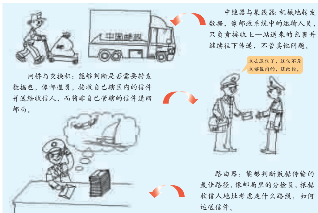
图 3-2 网络通信连接设备的功能
