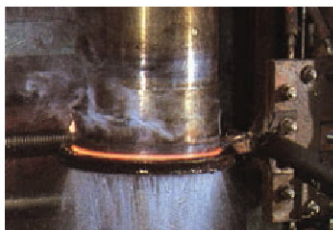
(a) 高频淬火——用高频电磁波快速加热齿轮齿表,然后快速冷却,使齿表耐磨
