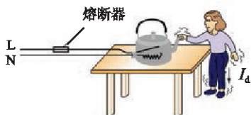
图 9-3-6 无保护接地，发生相线与用电器金属外壳连通故障时，有触电的危险
