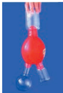
(d) 用开水把杯子烫热，立即扣在气球上，杯子为什么会牢牢地吸在气球上
