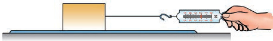
图 7-5-5 你很快就会学到，拉动木块匀速滑动，弹簧测力计的示数就等于滑动摩擦力的大小
