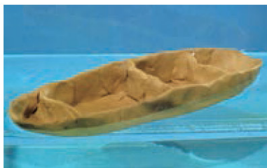
图 10-3-7 用橡皮泥捏成的小船浮在水面上
