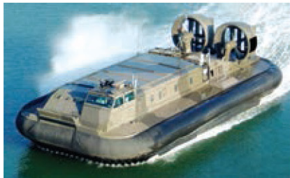
图 7-5-11 气垫船的船底与水面之间有一层空气,使船在航行中阻力减小
