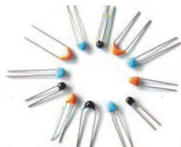
图 3-2-2 一些 NTC 热敏电阻。NTC 是 Negative Temperature Coefficient 的缩写，意思是“负的温度系数”，泛指电阻随温度升高而急剧减小的半导体材料或元器件
