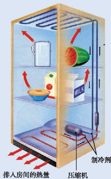
图 4-2-7 电冰箱的结构示意图
