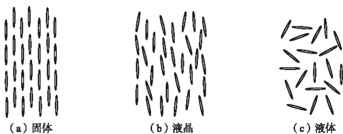
图 3-3-3 固体、液晶和液体分子的排列示意图
