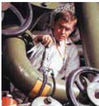
图 3-3-1 利用 \gamma 射线检查金属内部
