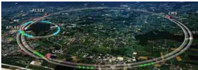
图 3-7-4 这是 LHC 的鸟瞰示意图, 它的周长高达 27 km, 主环跨越法国和瑞士国界。ATLAS、CMS、ALICE 和 LHCb 分别是不同的粒子探测器, 安装在四个地下巨洞中, 分布在 LHC 周围
