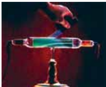
图 2-1-1 条形磁铁使阴极射线偏转
