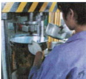
图3-22 压力将铝板压成锅
