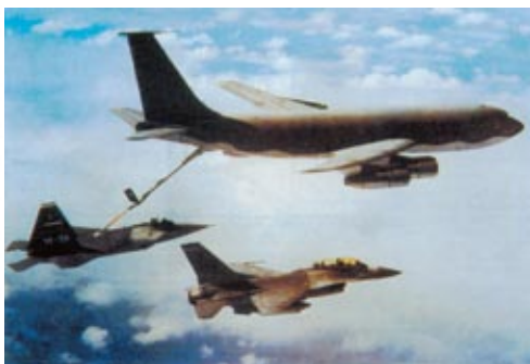
图3-3 飞机在空中加油时要求受油机和加油机保持相对静止
