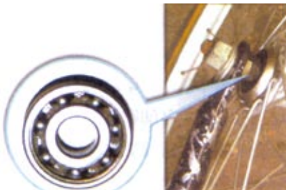
图3-80 用滚动代替滑动
