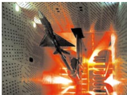
图3-4 在风洞中，高速气流通过静止的飞行器，与飞行器在空气中高速运动的效果相近
