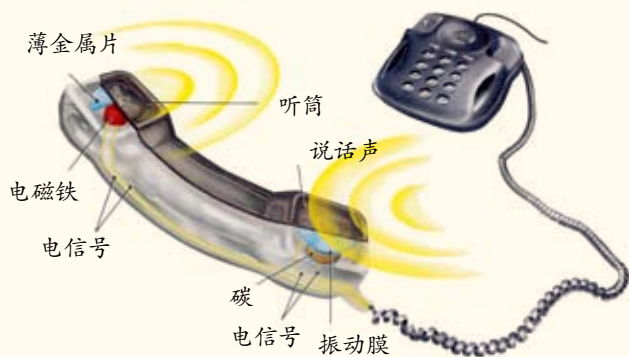
图1-38 电话机的原理
