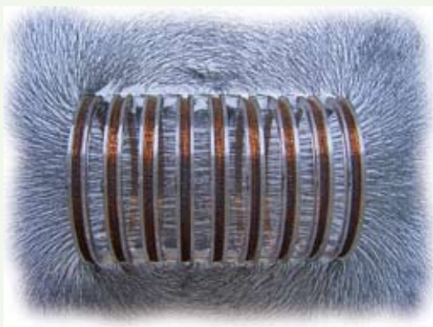
图1-24 通电螺线管的磁场
