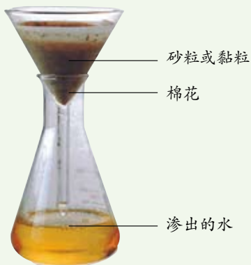
图4-11 土壤的渗水实验
