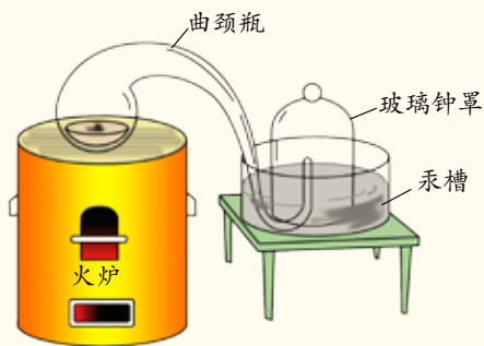
图3-19 拉瓦锡研究空气成分所用的装置
