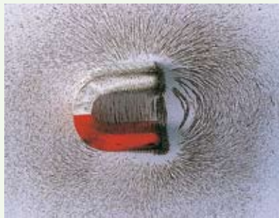
图1-11 蹄形磁铁的磁场
