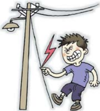
图1-71 人站地上手触火线时触电
