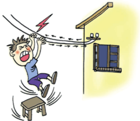
图1-72 人同时接触两根电线时触电
