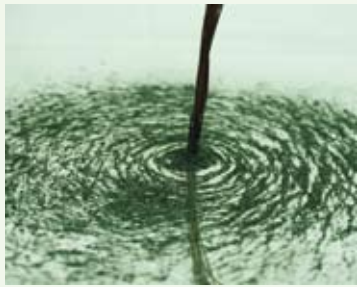
图1-21 直线电流的磁场
