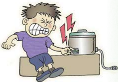
图1-70 无接地线时,带电的金属外壳会使人触电
