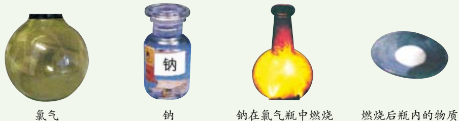
图2-17 钠在氯气中燃烧的实验
