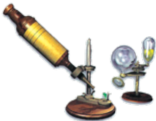
图2-6 胡克用的显微镜
