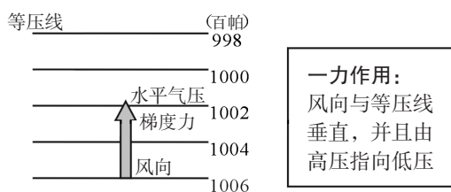
图甲 在水平气压梯度力作用下的风向
