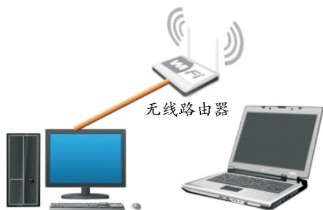
图1-36 两台计算机分别通过有线与无线方式连接到无线路由器上
