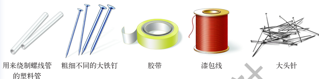
图 16-24 研究电磁铁磁性的实验器材
