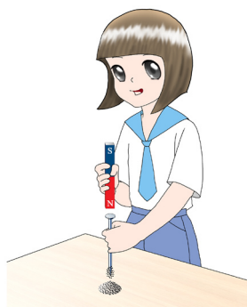
(a) 将磁铁的一极靠近或接触铁钉
