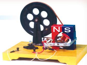
图17-15 手摇发电机模型
