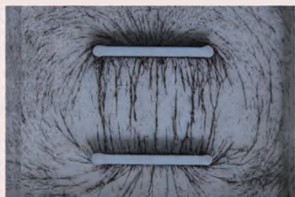
(a) 模拟带等量异种电荷的平行金属板的电场线
