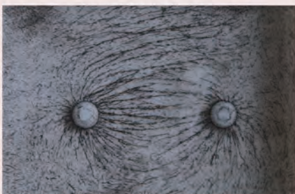
(a) 模拟等量异种点电荷的电场线
