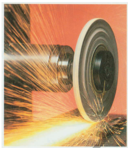
图 2-1-6 火星沿砂轮的切线飞出
