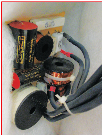
图 4-4-8 音箱里面的分频器
