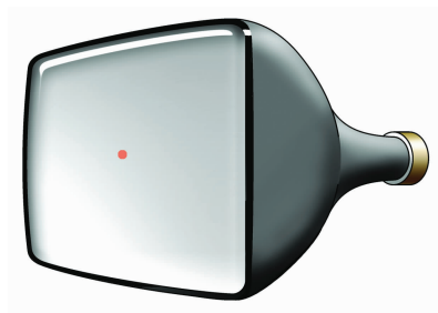
图 1-6-6 无外加磁场时电子束无偏转
