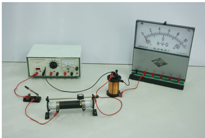
图 2-1-2 利用通电螺线管的磁场产生电流
