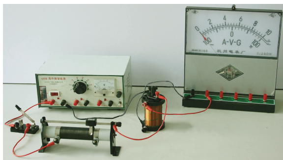
图 1-2-3 利用通电螺线管的探究实验
