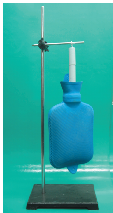
图 1-4-1 两段铅柱间的分子引力足以吊起 1 kg 重物
